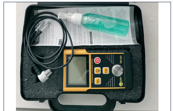
Wanddickenmessung mit Ultraschall
