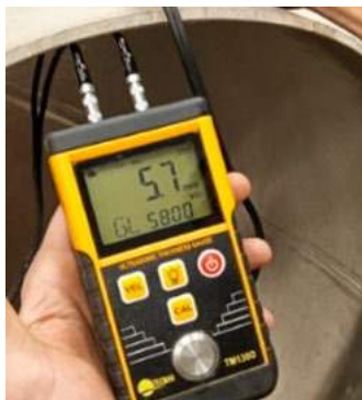
Ultraschallmessgerät TECMAN TM130D im Einsatz für die Messung an einem Edelstahlrohr
